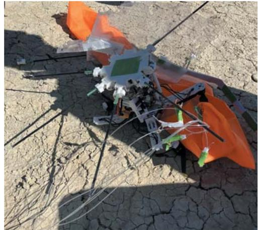
自由落下して大破した機体
