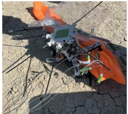
自由落下して大破した機体
